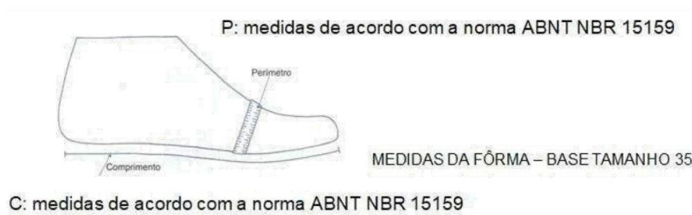
Figura 5 – Medidas da Fôrma
