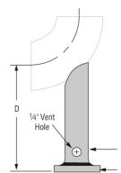
**Fig. 63 Type B S.R. Elbow**
