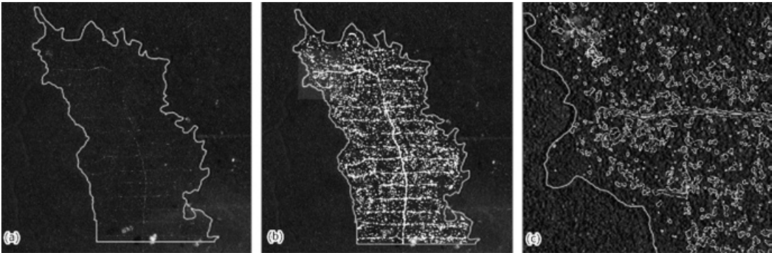
Figura 3 – Alertas de corte seletivo a partir de imagens Planet: (a) Área recém manejada; (b) Alertas de corte seletivo; (c) Detalhe dos alertas em clareiras e estradas. Fonte: SFB
