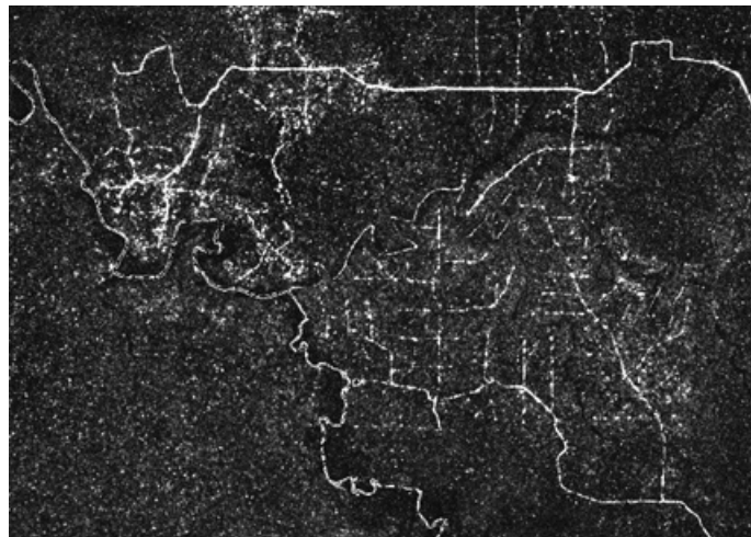
Figura 2 – Imagem DETEX, com realce das estradas, pátios e clareiras. Fonte: SFB
