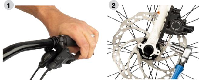
Mientras aprieta la manilla de freno, ajuste los pernos de la mordaza a 6 Nm. Esto debería alinear las pastillas de la mordaza de freno con el rotor.
