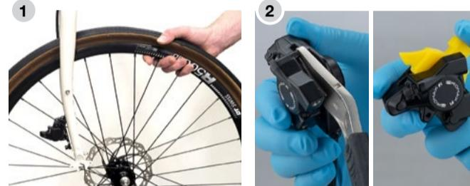
Quite las pastillas de freno con alicates de pinzas para evitar la contaminación con aceite mineral. Luego, con una prensa de pistón o un destornillador de punta plana, empuje los pistones hasta el tope, en la mordaza. Inserte el bloque de la mordaza en el hueco de la pastilla y sujetelo con un elástico. Coloque las pastillas de freno en un lugar limpio y seco.
