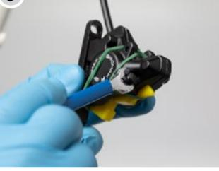
Desconecte la mordaza del cuadro/horquilla. Monte la jeringa de la mordaza instalando el tubo de plástico y conector de purga en la jeringa. Nota: No es necesario utilizar el perno del conector de purga (M6).
