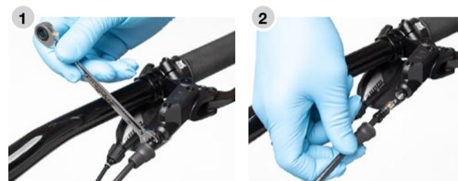
Retire la cubierta contra polvo, luego desenrosque la tuerca de compresión de la manilla con una llave de 8 mm. Mueva el tubo de freno de manera corta y repetida, y sáquelo con cuidado de la manilla de freno para evitar derramar el aceite mineral. Asegúrese de quitar la junta tórica también.
