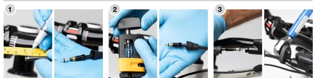
Presione la punta metálica en la punta del tubo. Asegúrese de que la punta metálica esté insertada por completo en el tubo y que el adaptador de bronce cubra la marca de 3,5 mm cuando se presione contra la punta metálica.
