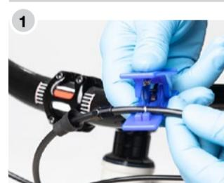
Pase el tubo a lo largo del cuadro. Asegúrese de que el tubo tenga combas adecuadas y que el manillar pueda girarse en ambas direcciones sin que tire del tubo. Marque el área de corte del tubo y córtelo a la longitud deseada.
