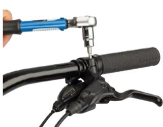
Quite el mango del manillar y deslice la nueva manilla de freno en el manillar. Vuelva a instalar el mango del manillar y ajuste la manilla de freno a su posición preferida. Apriete la manilla de freno a 3-5 Nm con un casquillo hexagonal de 4 mm.
