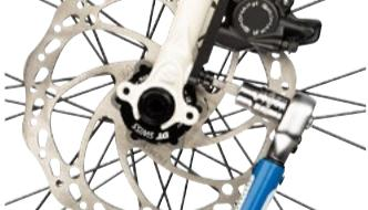
Apriete la manilla de freno para devolver los pistones a la posición correcta. Es posible que tome unas 3 o 4 aplicaciones para que las pastillas logren un contacto firme con el tiro adecuado de la manilla. Mientras aprieta la manilla de freno, ajuste los pernos de la mordaza a 6 Nm. Esto debería alinear las pastillas de la mordaza de freno con el rotor.
