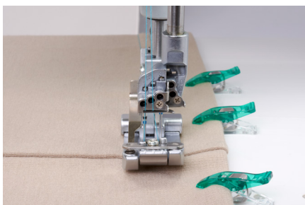
Pied Compensateur sur couture avec tissu tricot vue de face.
