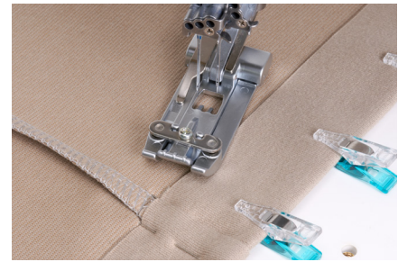
Dessous de l'ourlet montrant la position de la couture et des épingles.
