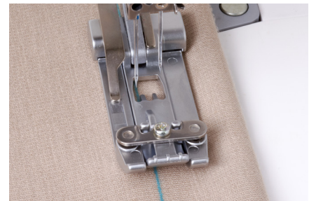
Alignement de l'aiguille C1 (gauche) avec l'encoche surélevée du Pied Compensateur et les repères sur le tissu.
