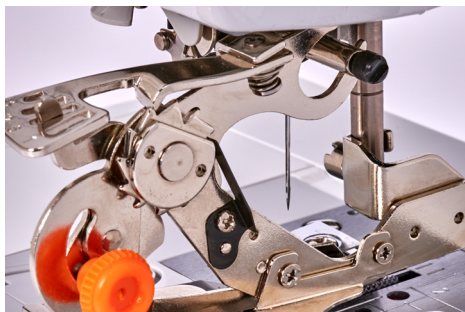
Guide Fourche (en forme de U) en position avec la Vis du Serre-aiguille.
