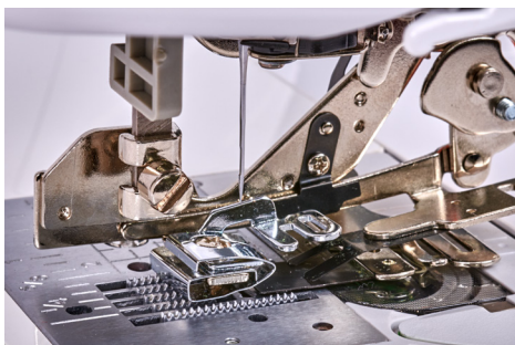
Guide en position sur la barre du pied presseur.
