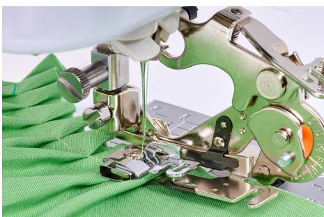
Coudre des volants/plis avec le pied Plisseur.
