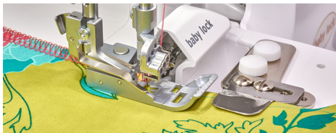
Couture au point de surjet à 4 fils avec fil décoratif dans chaque boucleur et fil de surjet dans les aiguilles.
