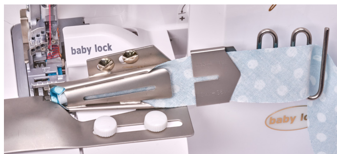
Bande de tissu insérée dans la fixation biais avec l'envers tourné vers l'avant.
