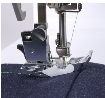
Réglage de l'angle du pied-de-biche pour s'adapter aux changements d'épaisseur du tissu (volume de la couture et de l'ourlet).
