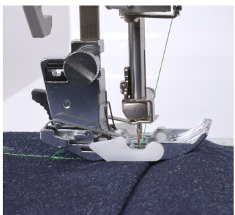
Le pied-de-biche se stabilise en se déplaçant sur le dessus de la couture.
