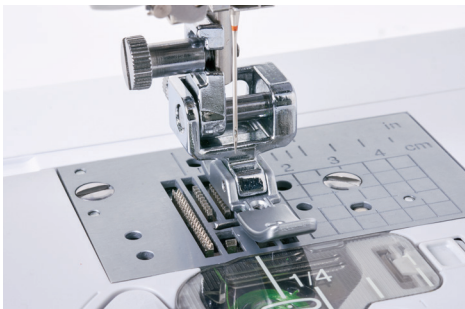
Le pied-de-biche se trouve sur l'ensemble droit des griffes d'entraînement, plaçant le tissu et la fermeture éclair ou le cordon sur le côté gauche du pied-de-biche et des griffes d'entraînement.
