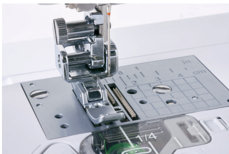
Le pied-de-biche se trouve sur l'ensemble gauche des griffes d'entraînement, plaçant le tissu et la fermeture éclair ou le cordonnet placé sur le côté droit du pied-de-biche et des griffes d'entraînement.
