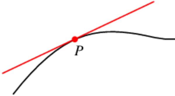
Si  $TP$  de la curva es un segmento de un círculo, es decir, un lado de un polígono de  $n$  número de lados, serian el segmento  $PT$  una prolongación de ese lado del círculo, o recta tangente en  $T$ , con misma pendiente .
