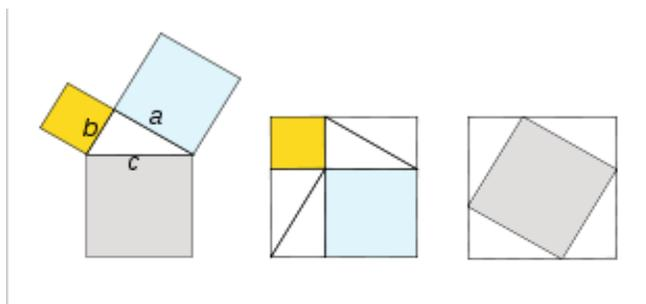
Los cuadrados compuestos en el centro y a la derecha tienen áreas equivalentes. Quitándoles los triángulos el teorema de Pitágoras queda demostrado.
