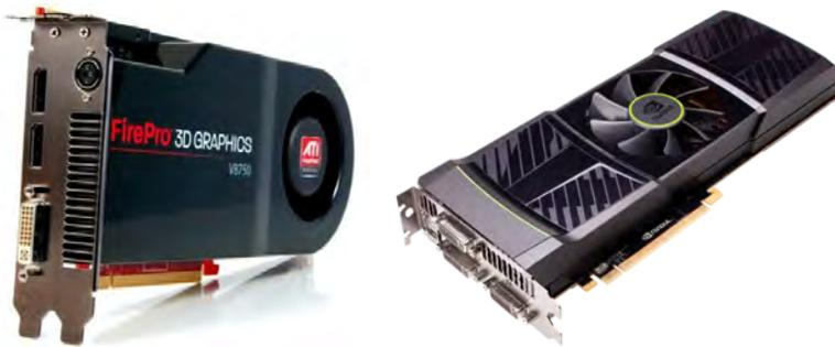
Figura 13. Tarjetas de aceleración gráfica con 512 núcleos y refrigeración controlada.
