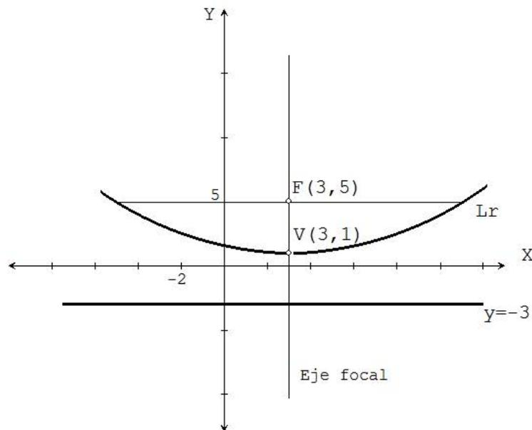
Se quiere construir una antena parabólica de manera que su receptor esté a una distancia de 0.5m del vértice. Hallar la ecuación de la parábola para su diseño.
