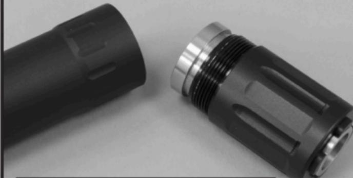
SEPARATE THE TUBE FROM THE BLAST CHAMBER
